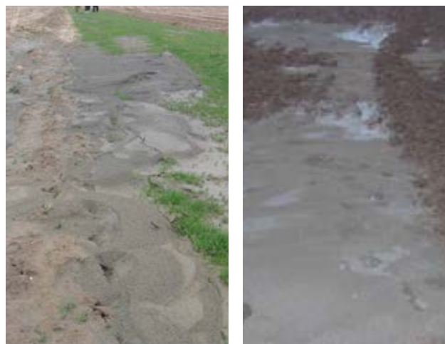
شکل ۱: جوشش ماسه و نشانه‌های وقوع روانگرایی
