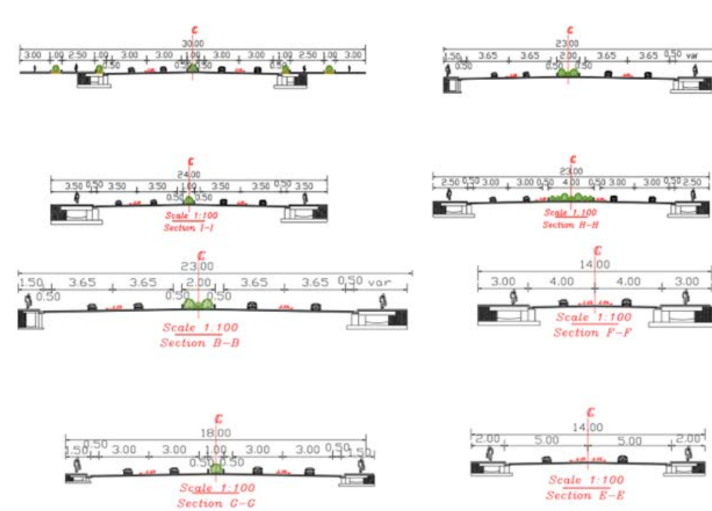
شکل ۲: تیپ مقاطع عرضی خیابان‌ها
